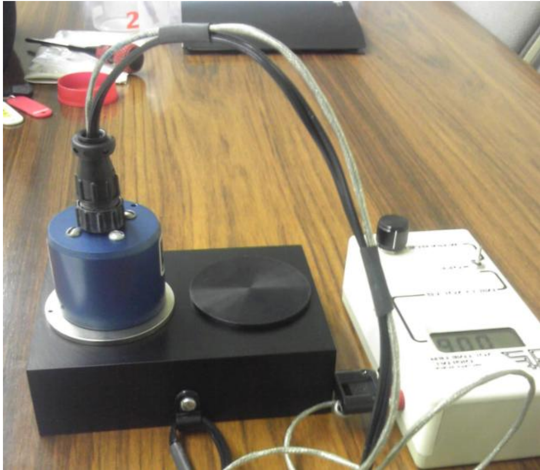
図1 D and S ARERD 放射率計の検出部とメーター部
